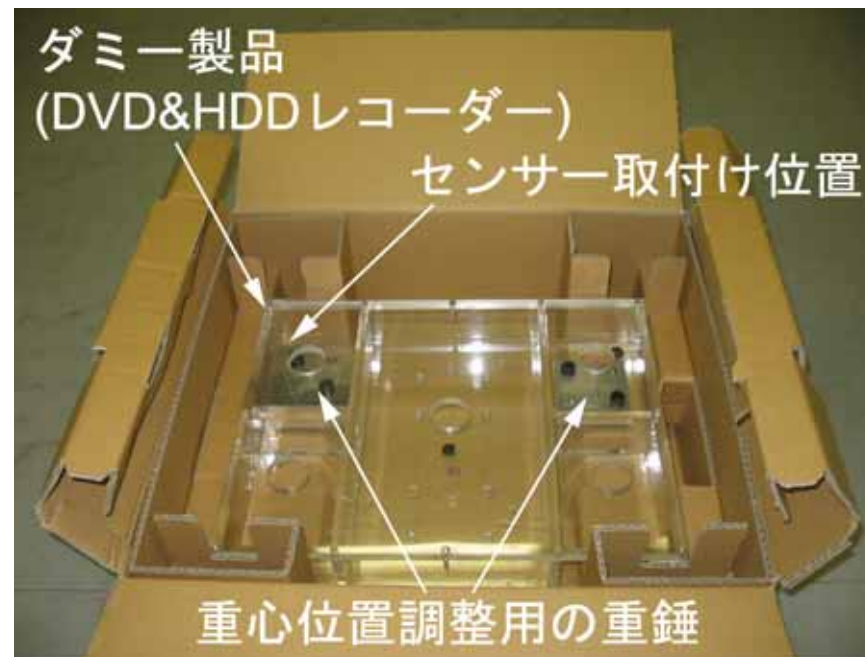
供試品として用いた DVDプレーヤー入り段ボール貨物
