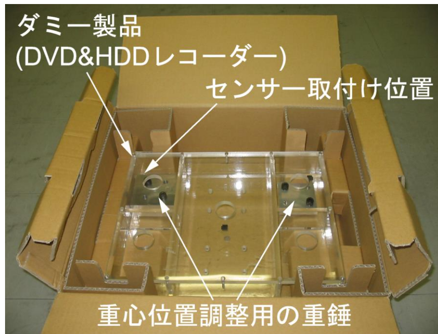
供試品として用いた DVDプレーヤー入り段ボール貨物
