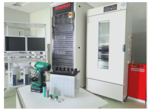
充放電試験装置(最大 20V・100A まで対応)
