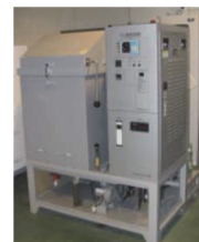
DIN50018 対応試験機 バッチ式 二酸化硫黄 (亜硫酸)ガス腐食試験機
