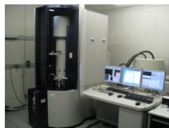
走査透過電子顕微鏡 (日立 HD-2700)
