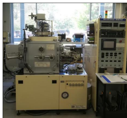
高密度プラズマアシスト製膜装置 神港精機株式会社 製 (機器型番：ACV-1060)
