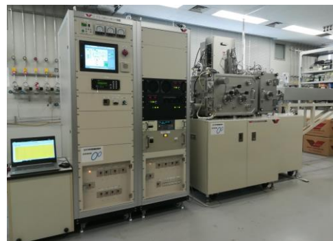
マグネトロンスパッタ装置 大阪真空機器製作所 製 (機器型番：MS-3C100L)
