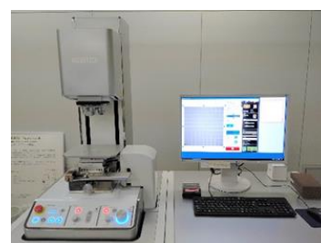
白色干渉型表面形状測定機 株式会社東京精密 製 (機器型番：Opt-scope R)
