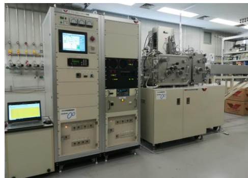
マグネトロンスパッタ装置 大阪真空機器製作所 製 (機器型番：MS-3C100L)
