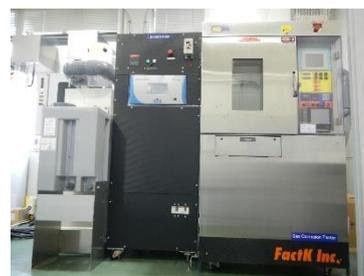
二酸化硫黄ガス腐食試験 (連続フロー式)
