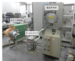
雰囲気式電気炉(脱脂炉)
