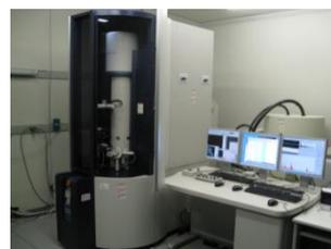
球面収差機能付走査透過電子顕微鏡
