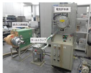
雰囲気式電気炉(脱脂炉)
