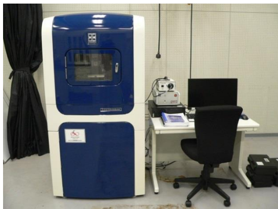
ナノインデント (HYSITRON 社製 TI 950 TriboIndenter)
