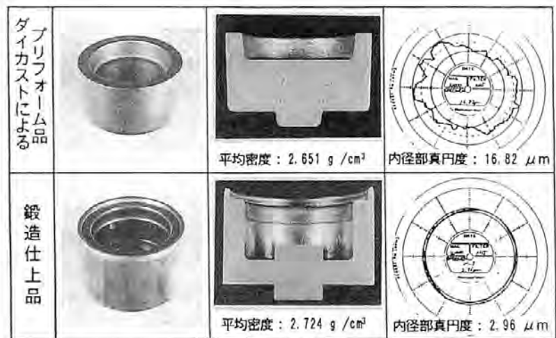
図6 ダイカストによるカップ状プリフォームの鍛造事例
