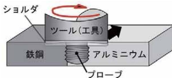
図 3 摩擦攪拌接合 (FSW) の模式図
