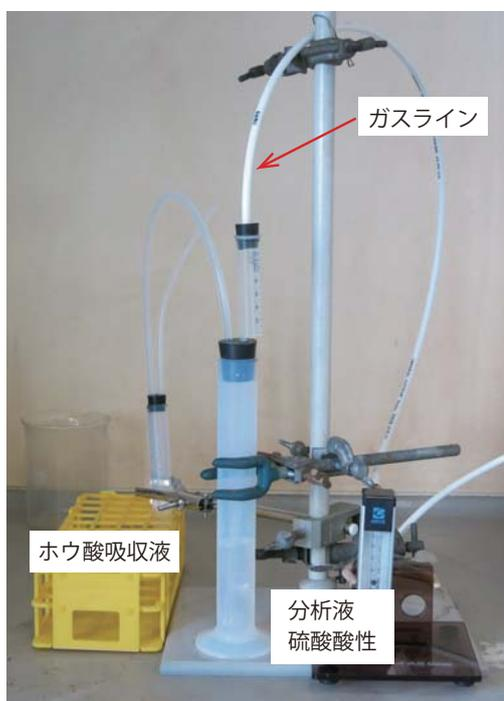
図 1 ふっ化物分離法装置の概観
