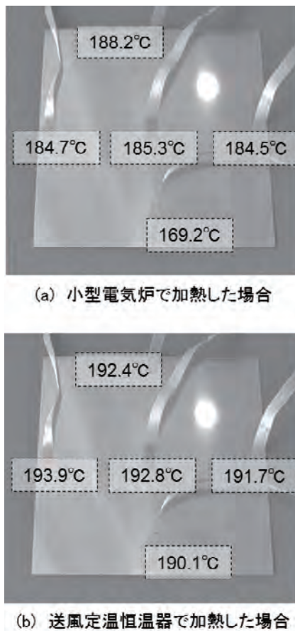
図 7 素板加熱時の温度分布
