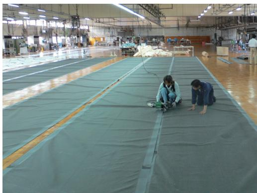
図8 工場での広幅加工状況
