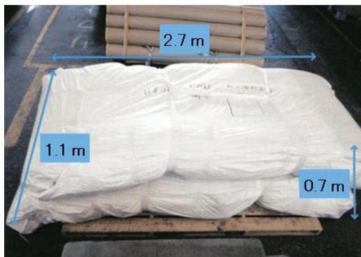
図9 広幅加工後に折り畳まれたガス透過性防水シート(梱包済)
