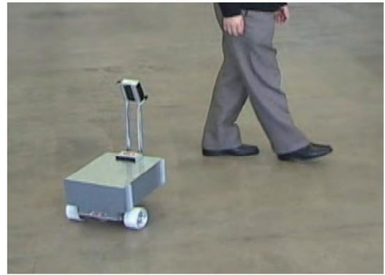
図3 試作人体追尾ロボット
