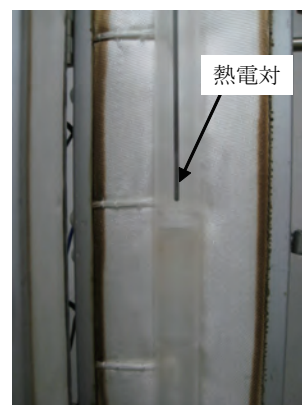
図8 流動層CVD試験装置内部
