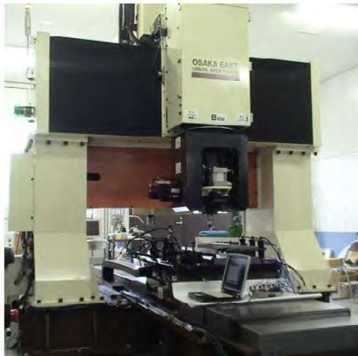
図1 開発したFSW装置の全景 Configuration of FSW equipment.
