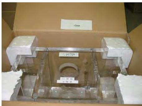
図4 複合荷重負担実験の試料
