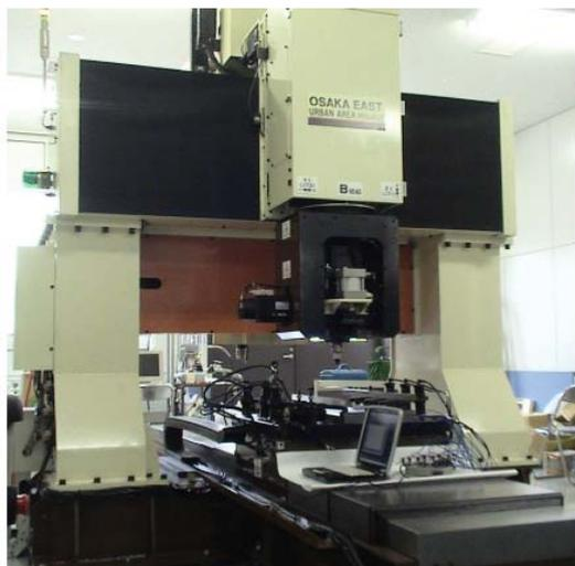
図1 開発したFSW装置の全景
