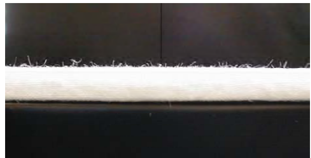
図10 pH 7.0, 50 °C の中性条件下、修飾酵素で200分処理したラミー生地の毛羽状態
