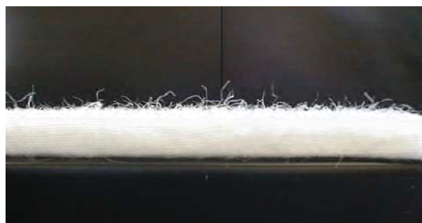
図6 酵素(アミラーゼ)糊抜き剤処理後のラミー生地表面。多くの毛羽立ちが生じている。
