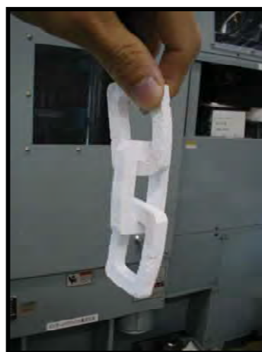
図6 BIP法による \text{Al}_2\text{O}_3 成形体
