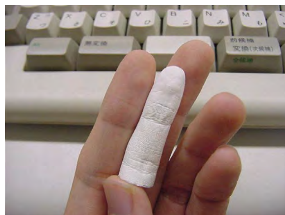
図5 \text{Al}_2\text{O}_3 製の指の模型
