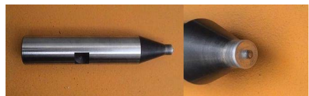
図4 FSW用ツール 右図は先端を拡大したもの (ショルダー径: 12 mm, プローブ径: 4 mm)
