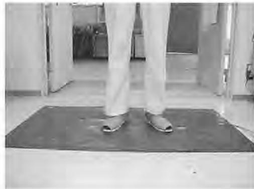
図7 マット型アンテナとIDタグ付きスリッパ
