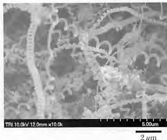
図7 Fe/ITO触媒から作製したCNCのSEM像
