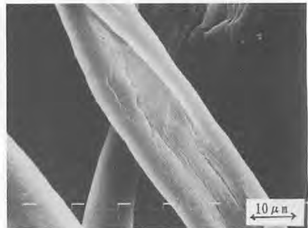
図7 未精製の修飾酵素で処理した精練綿糸の繊維表面SEM写真
