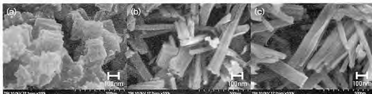
図3 メタノール中におけるTi(OPr) 4 の反応により得られたTiO 2 微粒子のSEM写真 攪拌時間 (a) 5分, (b) 60分, (c) 120分
