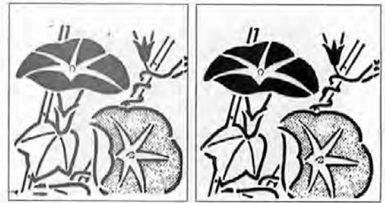
図11 ポリチオフェンのエレクトロクロミズム 左:脱ドーブ状態 右:ドーブ状態
