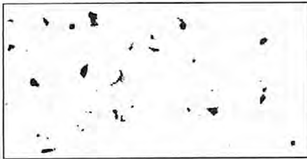
図7 耐圧試験後の圧力測定フィルム
