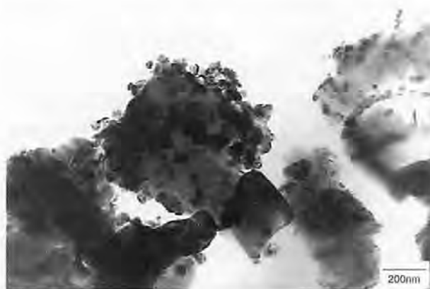
図2 共沈法により作製したアルミナ-ジルコニア複合粉末の電子顕微鏡写真
