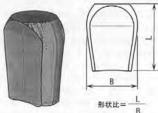
図2 試験片の変形と形状比
