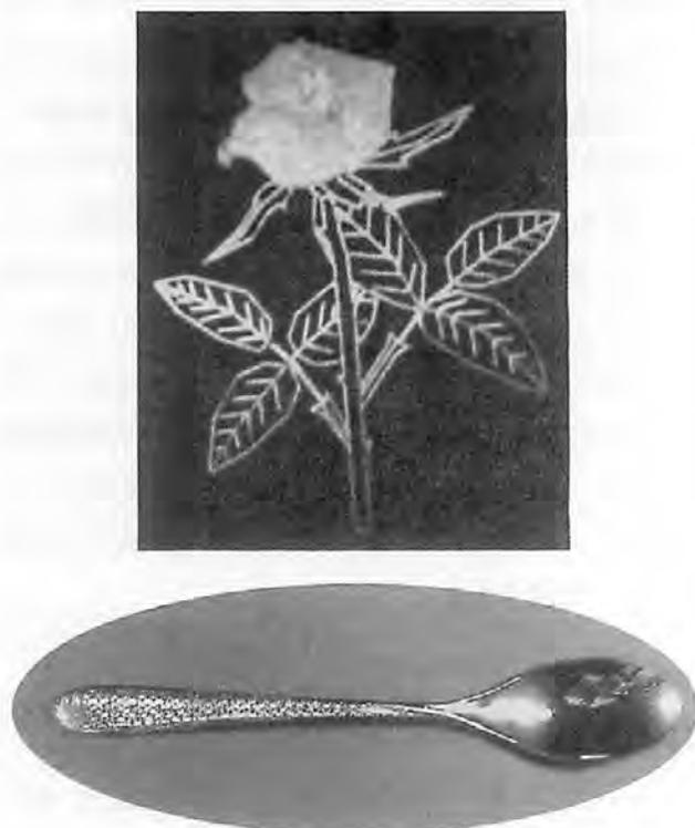
図10 ステンレス板および市販スプーンの緩やかにカーブしている柄へのレインボーカラー加工
