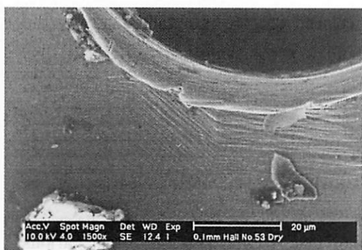
図 13 加工穴周辺の電子顕微鏡写真 SEM micrograph around drilled hole
