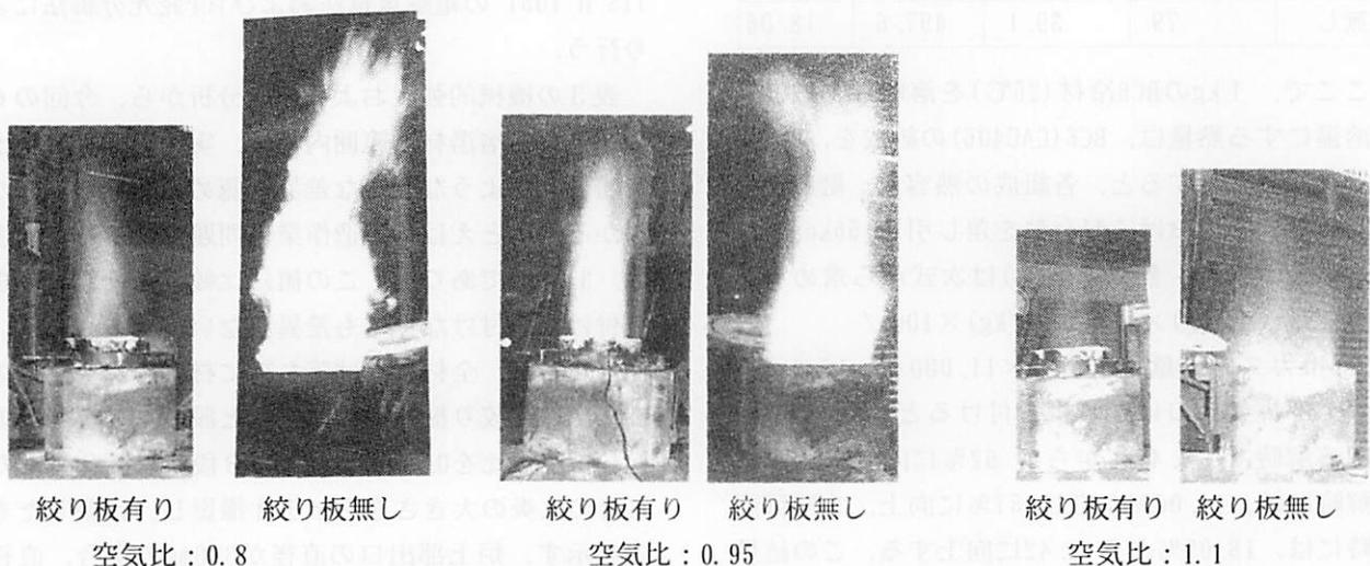
図2 炉上部出口径を絞ることによる火炎の大きさの違い
