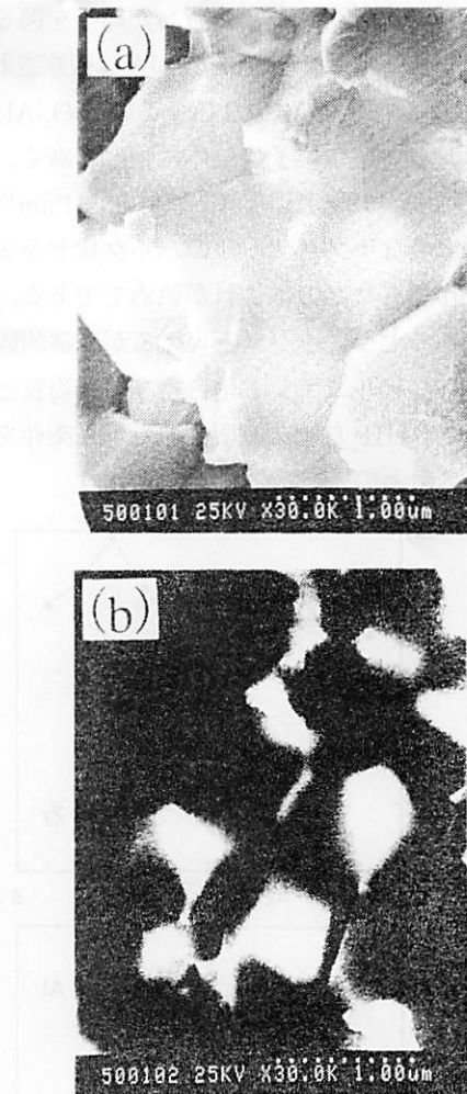
図8 Al 2 O 3 -ZrO 2 系高強度セラミックスの破断面のSEM写真；(a)二次電子像、(b)反射電子像
