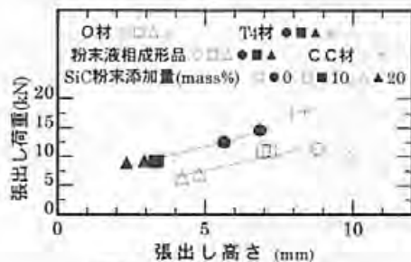
図10 張出し試験結果 Result of bulging test
