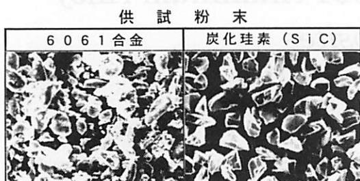
図1 供試粉末の粒形写真
