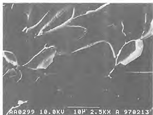
図23 Ep/MNA[B]の破壊じん性試験後の破断面SEM写真
