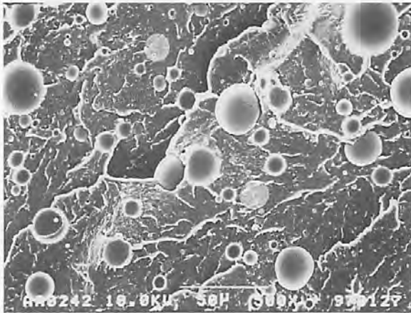
図15-a PP/PS=70/30の破断面SEM写真
