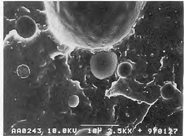
図15-a PP/PS=70/30の破断面SEM写真
