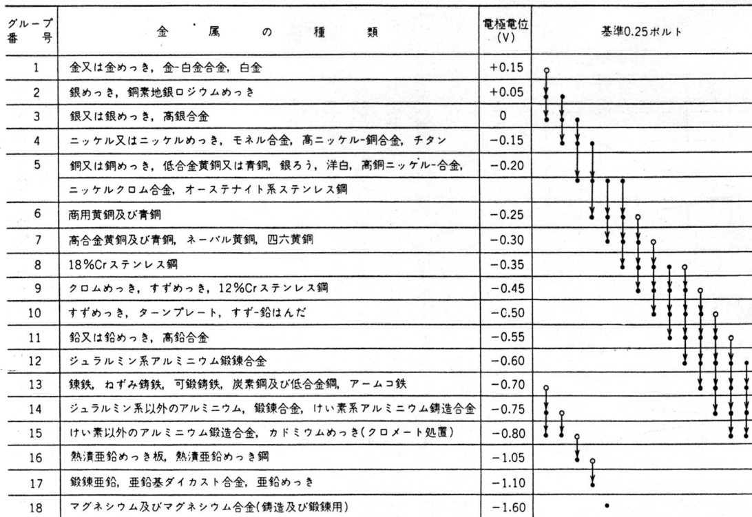
図5 許容しうる異種金属の組合せ(米軍規格)
