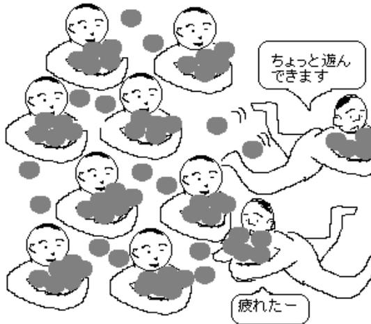
カチオンを含む水溶液に金属を浸すと、金属の表面からカチオンが飛び出し、同じ数のカチオンが金属の表面に原子として戻る。この状態を平衡という。このときアニオンの数は変わらないが、挙動ははっきりしない。
