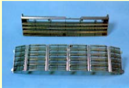
プラスチックめっきされた自動車部品 (ABS)
