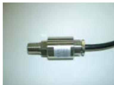
図 4 実用化した高温動作型圧力センサ
