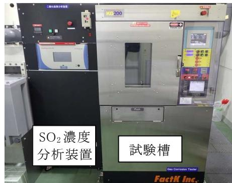
図1. 二酸化硫黄ガス腐食試験機
