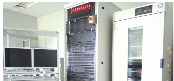
図2. 当所保有充放電装置の外観（左より制御用PC、充放電装置、恒温槽）
