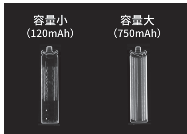
図5. 単4形ニッケル水素電池の X 線 CT 観察像
