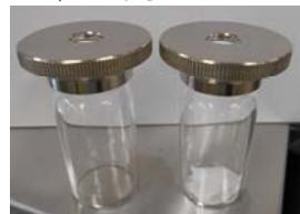
写真2 測定用試料瓶(左;ブランク、右;試料入)
