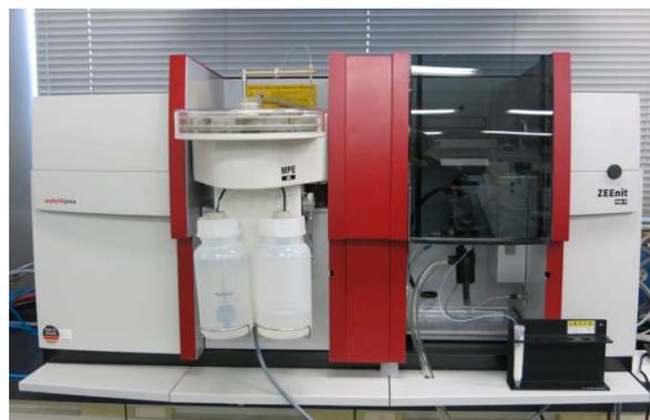
図1 原子吸光装置 (アナリティクイエナ製 ZEEnit700P)
