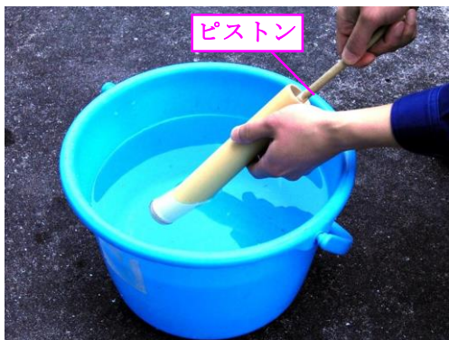
図 4 竹鉄砲への水の吸引
