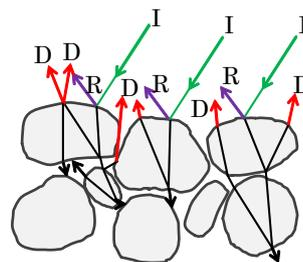
図 1. 粉体試料での赤外光拡散の様子
